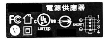
触入:100-240VAC 50/60Hz 0.2A 触出:5.0V:::1000mA
