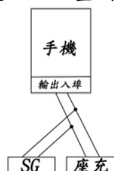
11. 針對 FM Band 的傳導測試，FM Band 的頻率皆落於傳導測試頻率範圍外，貴局要求 FM band 測試時，傳導測試時應作高、中、低三個頻率測試；依電路特性，FM Band 第一中頻雖為 10.7MHz，但其電路構造並不是主動元件(即 Noise Source)，Noise Source 於本地震盪及混波器，此部份的雜訊頻率，皆未落於傳導測試頻率範圍內，當然於調諧電路上，可能會發生混附雜波發生，但依電路特性屬性，得知若混附雜波發生，也絕對與本地震盪及混波器的雜散電容引起有關，因此若有此依現象，測試任何一個 Band 皆會發生，不會測試三個 Mode 方能得知此一結果，故建議"此項測試應可接收驗證一個 FM Band 的傳導測試"
